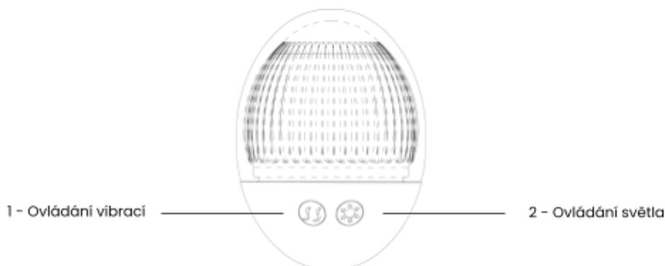
Dlouhým stisknutím tlačítek (1, 2) po dobu 2 vteřin zapínáte a vypínáte jednotlivé funkce. Krátkým stisknutím těchto tlačítek pak přepínáte mezi jednotlivými módy vibrací a osvětlení.
